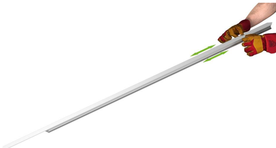
5.28. ábra: Borítószalagból kb. 3 cm-t helyezzen fel
